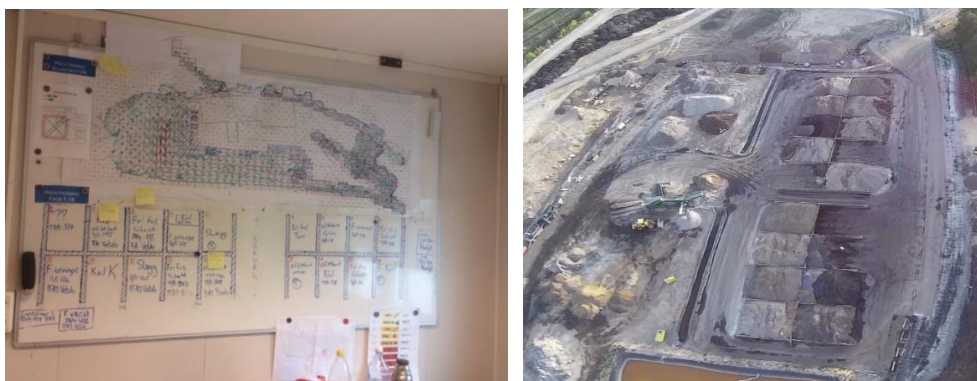
Figur 5-6. De olika facken i verkligheten (höger) samt på en tavla i fikarummet (vänster) där all information fanns uppdaterad om vad som låg i facket, föroreningsgrad och vart det skulle transporteras.
